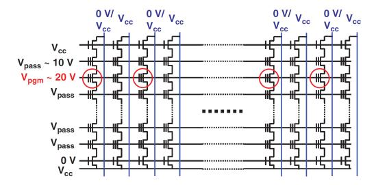
Abbildung 2.12.: Programmierung eines NAND-Flasharrays [ARI16]
