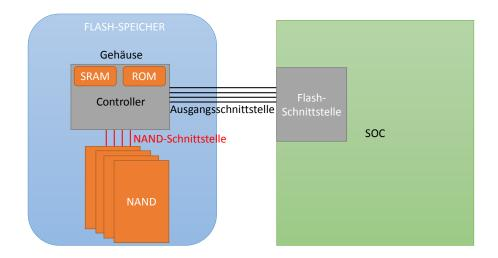
Abbildung 2.26.: Hardwareumfeld eines Flash-Arrays mit Speicher-Package und SoC
