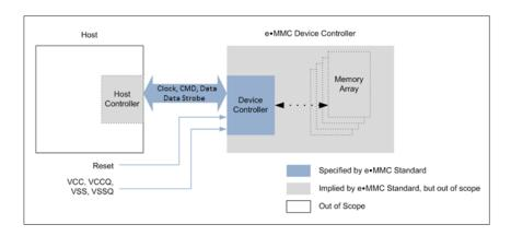
Abbildung 2.33.: Schnittstellenaufbau eMMC[JED15]
