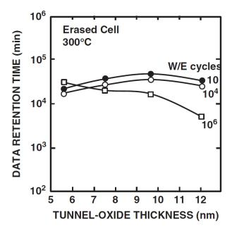
Abbildung 2.15.: Data Retention-Zeit bei 300°C in Abhängigkeit der Tunneloxiddicke und den P/E-Cycles[ARI16]
