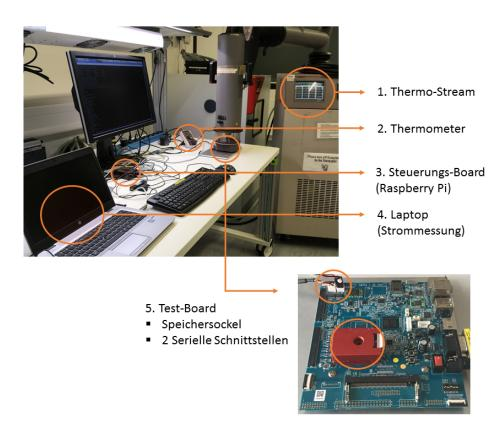
Abbildung 5.4.: Hardware Setup mit Temperaturmessung
