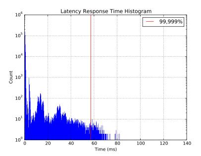
Abbildung 7.7.: Testergebnisse für den 59s-Test(Latenz) für UFS von Hersteller 1
