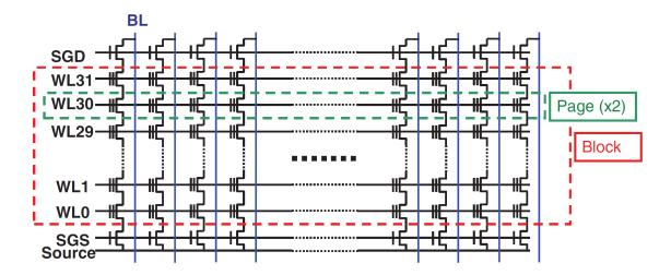
Abbildung 2.8.: Array-Architektur von NAND-Speicherzellen [ARI16]
