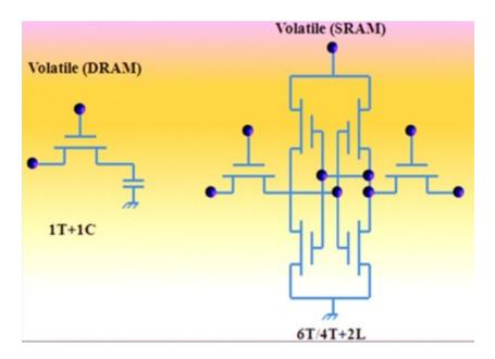
Abbildung 2.2.: Schaltungsaufbau von DRAM und SRAM [MSCT14]
