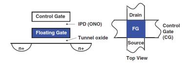
Abbildung 2.4.: Architekur einer Flash-Einzelzelle mit Floating Gate [ARI16]
