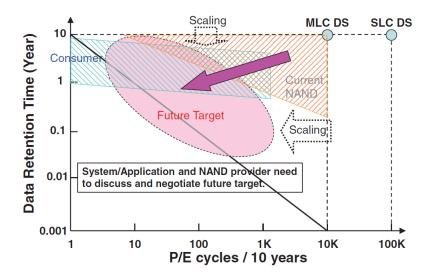
Abbildung 2.18.: Trade-Off zwischen Data Retention-Zeit und P/E-Cycles[ARI16]
