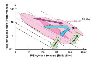
Abbildung 2.19.: Trade-Off zwischen Pr<br/>grammiergeschwindigkeit und P/E-Cycles [ARI16]
