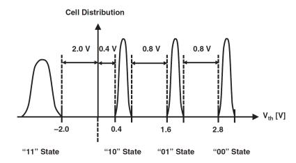
Abbildung 2.13.: Verteilung der Grenzspannungen auf vier Zustände bei Multilevel-Zelle [ARI16]
