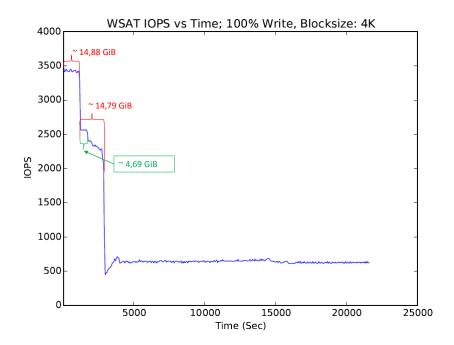
Abbildung 7.10.: Ergebnisse für des WSAT-Tests für UFS 1 mit geschriebener Datenmenge
