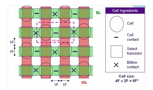
Abbildung 2.3.: Array-Layout mit einer  $8F^2$  Strukturgröße
