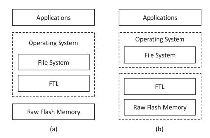
Abbildung 2.29.: FTL-Architekturen: a) Betriebssystem mit FTL-Funktionen b) FTL in der Firmware des Speichers integriert [MFL14]
