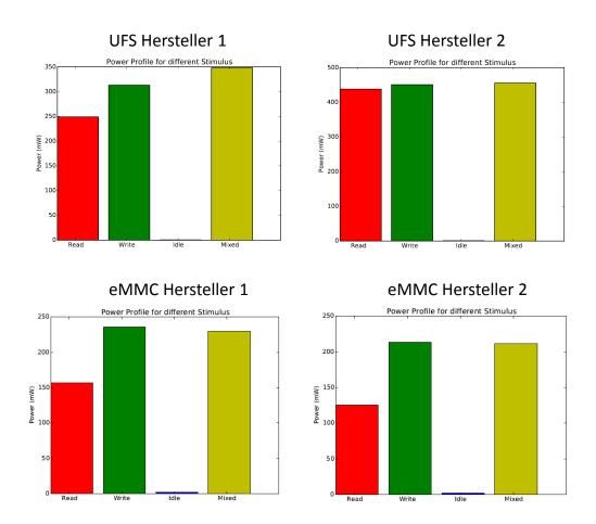
Abbildung 7.11.: Testergebnisse für den Strom-Test für beide UFS- und eMMC-Speicher
