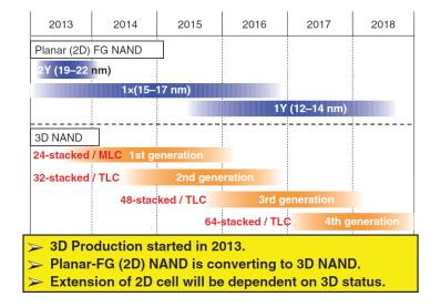
Abbildung 2.22.: Übergang von der planaren 2D-NAND-Zelle zu einer 3D-NAND-Zelle[ARI16]
