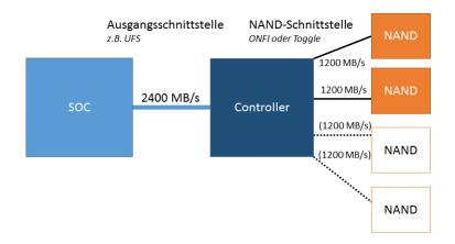
Abbildung 2.28.: Überblick zu Schnittstellen im Managed NAND
