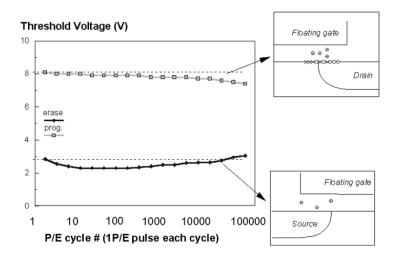
Abbildung 2.17.: Bilden eines Spannungsfensters als eine Funktion von P/E-Cycles bei einer Flash-Einzelzelle [BCMV03]
