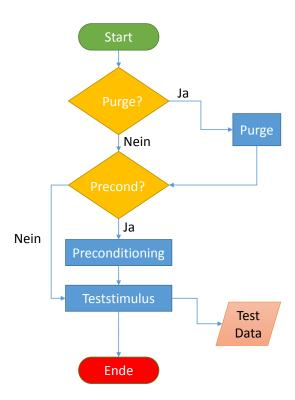
Abbildung 5.12.: Ablaufdiagramm eines Einzeltests
