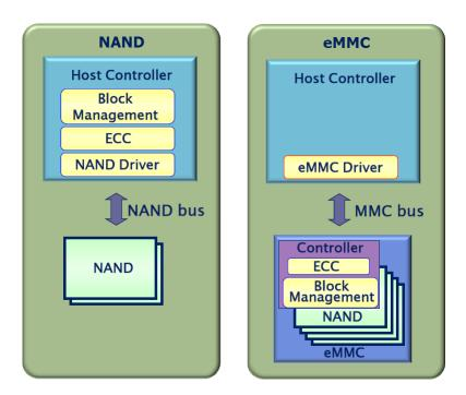
Abbildung 2.27.: Aufbau von unmanaged NAND und managed NAND(eMMC)
