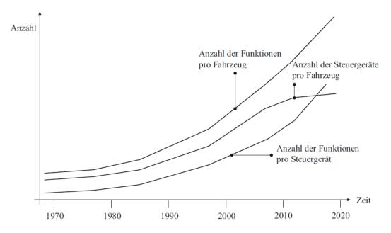
Abbildung 1.1.: Funktionen und Steuergeräte pro Fahrzeug [SZ16]
