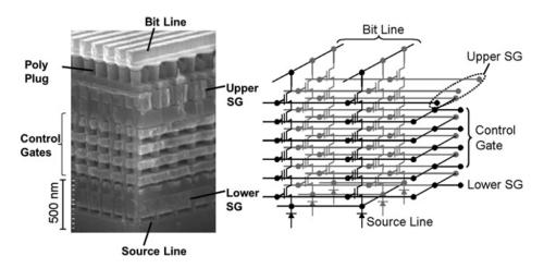
Abbildung 2.24.: BiCS-Zelle unter Rasterelektronenmikroskop und äquivalente Schaltung[ARI16]
