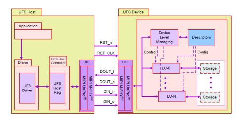
Abbildung 2.35.: Schnittstellenaufbau UFS[JED]
