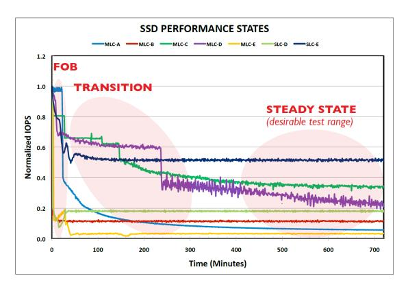
Abbildung 3.2.: Flash Performance States am Beispiel verschiedener SSDs [EAW]
