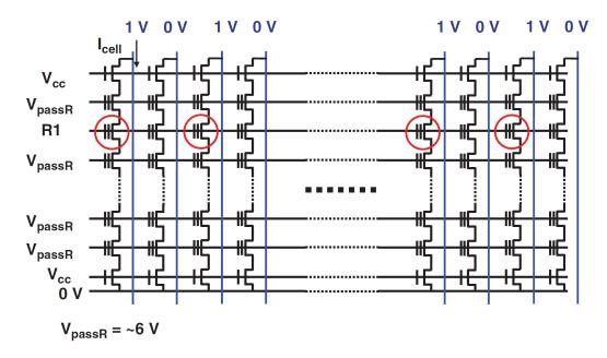
Abbildung 2.10.: Schaltung einer Leseoperation bei einem NAND-Array [ARI16]
