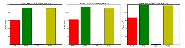
Abbildung 7.12.: Strom-Test für eMMC 2 unter verschiedenen Temperaturbedingungen (-20, 20, 65 Grad Celsius von links nach rechts)
