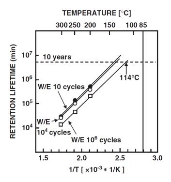
Abbildung 2.14.: Schätzung der Data Retention-Zeit im Bezug auf die Betriebstemperatur [ARI16]
