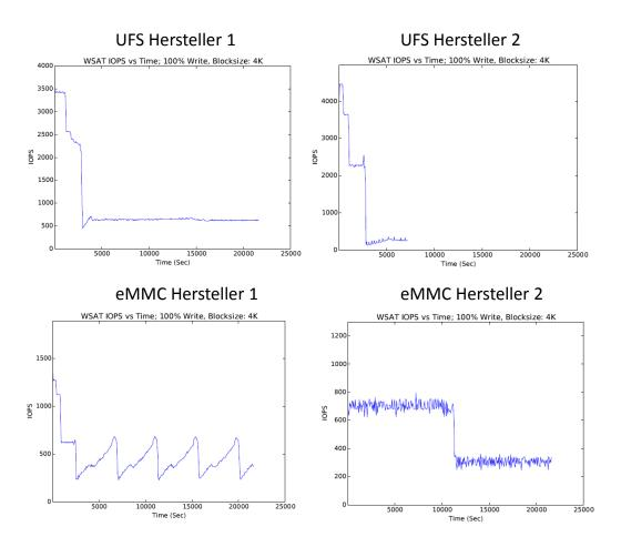
Abbildung 7.9.: Testergebnisse für den WSAT-Test für beide UFS- und eMMC-Speicher
