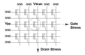
Abbildung 2.16.: Schema eines Flash-Arrays, das durch P/E-Cycles entstandene Row und Column Disturbs zeigt[BCMV03]
