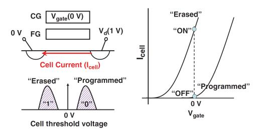
Abbildung 2.9.: Prinzip des Lesevorgangs einer Flash-Einzelzelle [ARI16]
