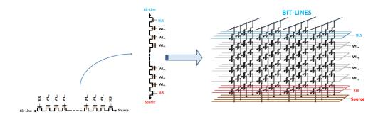
Abbildung 2.23.: Übergang des NAND-Strings von horizontaler Ebene in die Vertikale<sup>2</sup>
