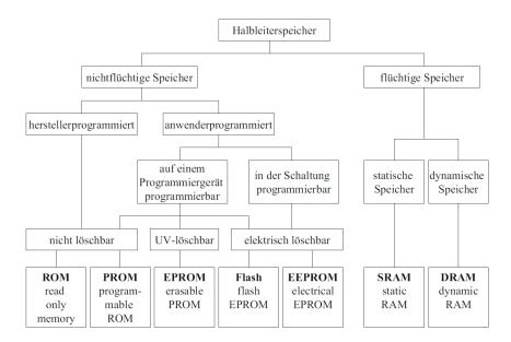
Abbildung 2.1.: Übersicht von Speichertechnologien [SZ16]
