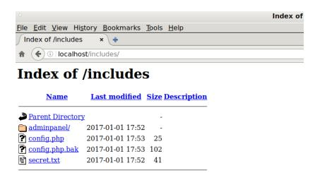
Abbildung 2.6.: Fehlkonfiguriertes Directory Listing
