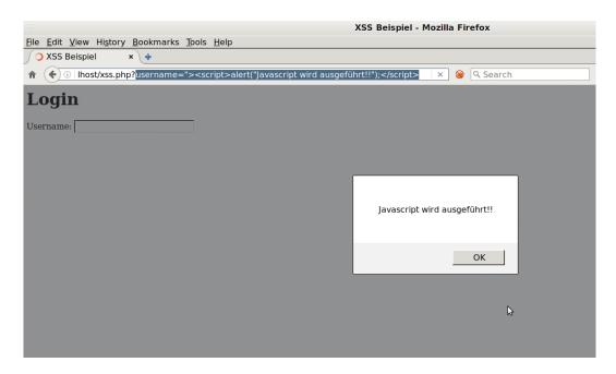
Abbildung 2.5.: Resultat einer XSS Schwachstelle
