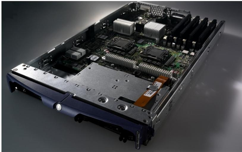
Abbildung 3.7: Ein Blade der Firma Dell - Modell Poweredge 1955 (Quelle: [del 07])
