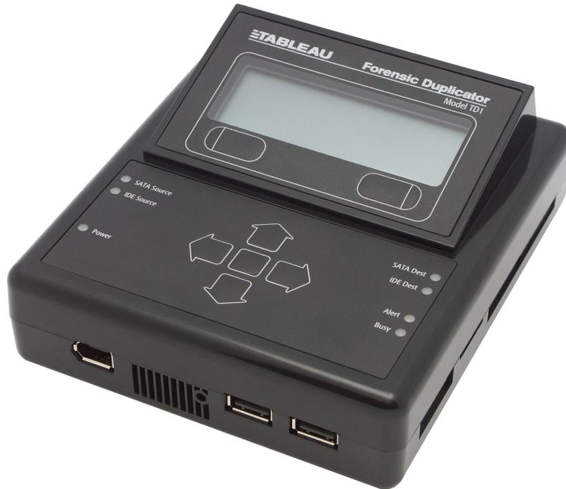
Abbildung 5.23.: Ein Write-Blocker unterdrückt Schreibzugriffe auf Datenträger.
