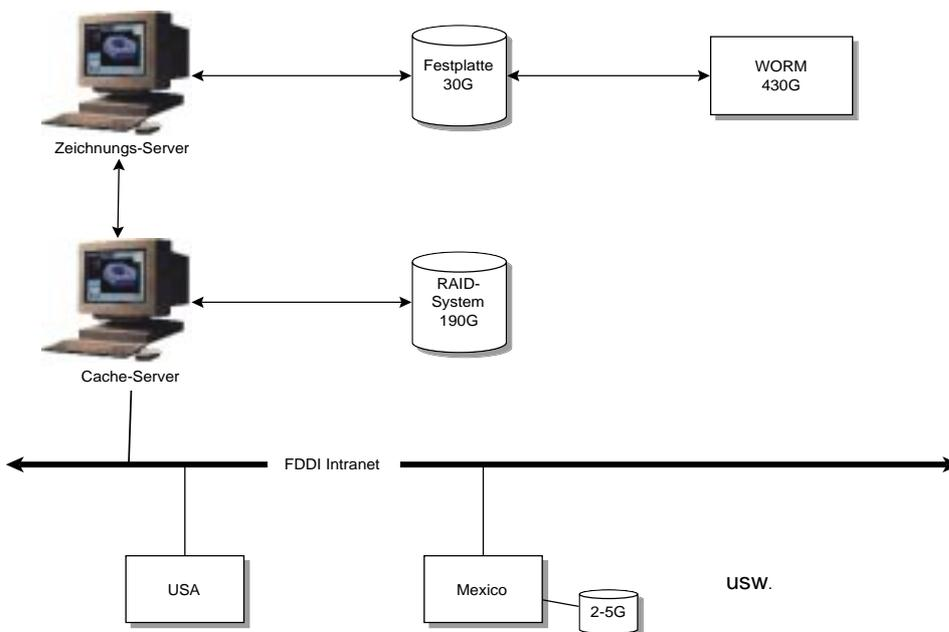
Als zentraler Cache-Server für die Zeichnungen steht eine Sparc-Station 1000 zur Verfügung. Sie verfügt über ein 190 Gigabyte großes RAID-Plattensystem, von dem 44 Gigabyte als Cache für die Zeichnungen genutzt werden können. Die zentrale Speicherung der Zeichnungen erfolgt auf einem 430 Gigabyte großem WORM-System, auf das über eine Sparc-Station 10 zugegriffen
