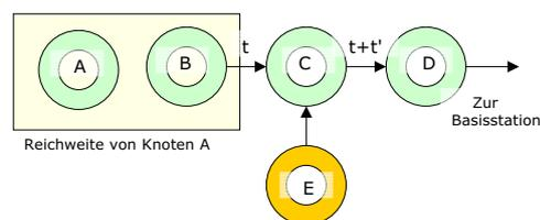
B sendet zum Zeitpunkt  $t$  an Knoten C. Knoten A hört diese Übertragung. Er weiß, dass C das Paket innerhalb der Zeit  $(t - t')$  an D weitersenden wird, und wartet genau diese Zeit ab, um eine Kollision in B zu verhindern.
