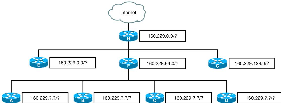
Die Abbildung zeigt die vollständige Infrastruktur des ISPs. Die Router A-H sind Zugangspunkte zu öffentlichen, d.h. vom Internet aus erreichbaren, Subnetzen, innerhalb des dem ISP zugewiesenen Adressbereichs. Die unvollständig ausgefüllten Kästen (Beschriftung) geben Hinweise auf die Einteilung der Subnetze bzw. welches Subnetz der jeweilige Router mit dem Internet verbindet.
